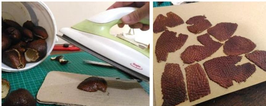
Gambar 4. Proses laminasi panas & hasil laminasi kulit salak
